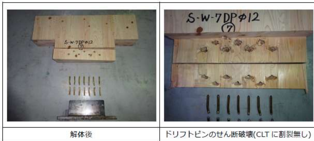
写真：接合部破壊状況（弱軸方向）
