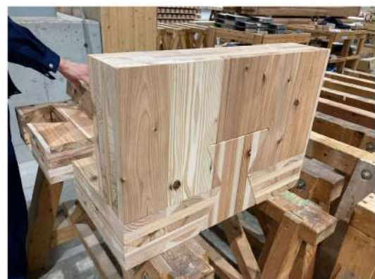
高耐力CCU 蝶蟻部組立 要素試作実験 (SAI開発/ミヨシ加工) R8
