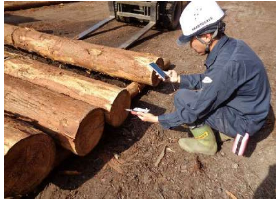
写真 1. 原木の強度測定及び仕分けの様子
