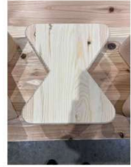
高耐力CCU 蝶蟻 R25 (銘建試作品) 2
