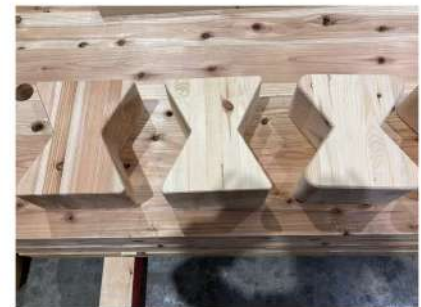
高耐力CCU 蝶蟻加工 比較 3 (SAI開発、ミヨシ試作、銘建試作) R25/R8
