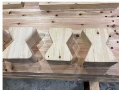
高耐力CCU 蝶蟻加工 比較 2 (銘建試作、ミヨシ試作、SAI開発) R25/R8
