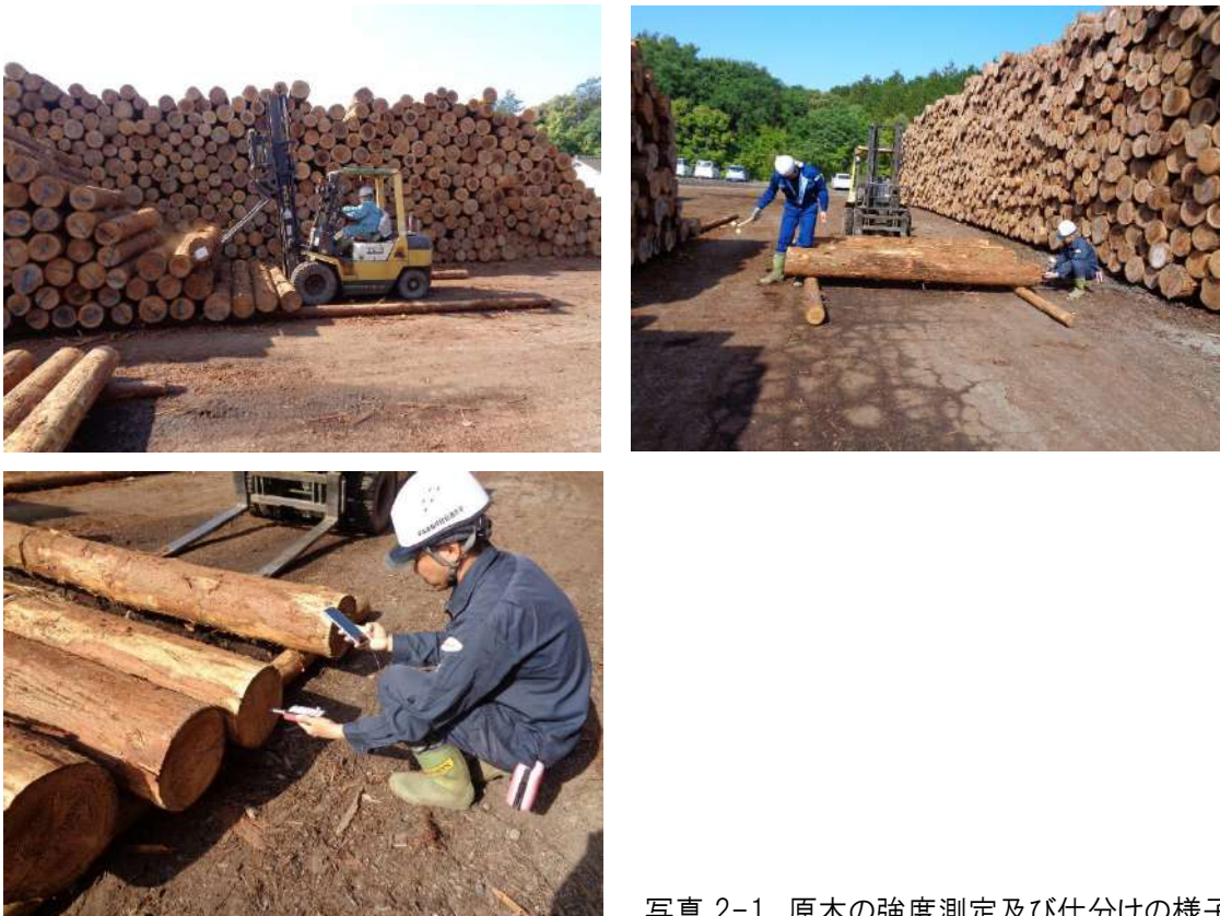
写真 2-1. 原木の強度測定及び仕分けの様子
