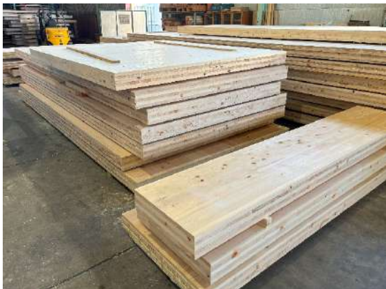
【加工工場 CLT 保管状況】
