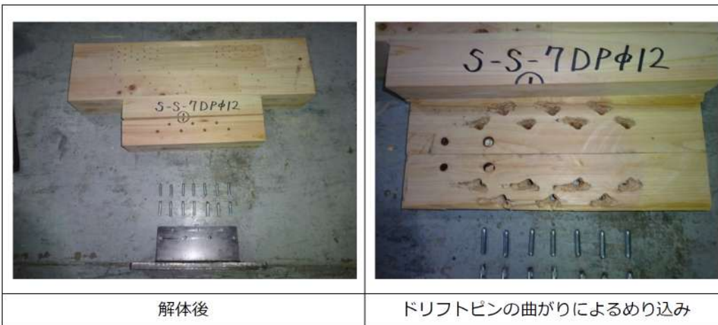
写真：接合部破壊状況（弱軸方向）
