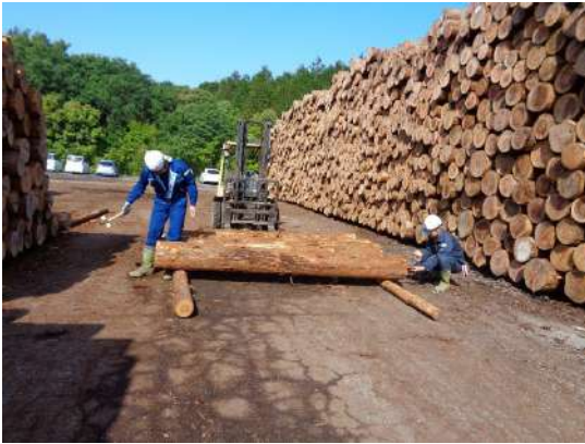
写真 1. 原木の強度測定及び仕分けの様子
