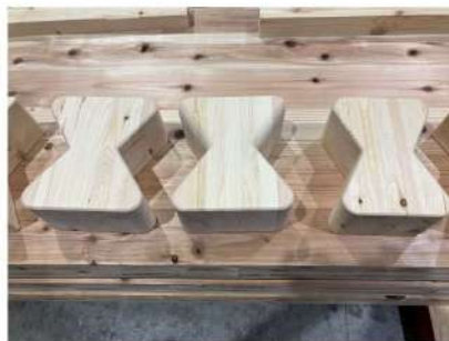
高耐力CCU 蝶蟻加工 比較 1 (銘建試作 2、ミヨシ試作) R25
